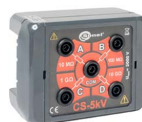
CS-5kV cali- bration box
